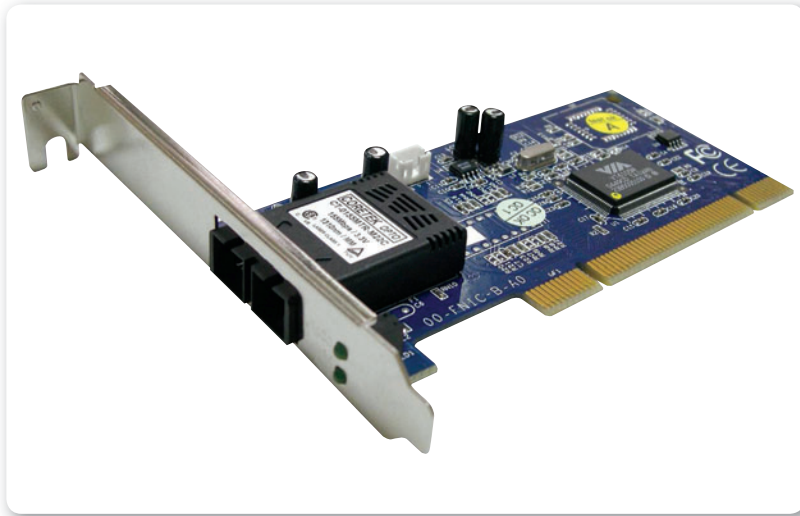
Figura 4. Los equipos informáticos precisan contar con una interfaz de red para compartir contenidos.
