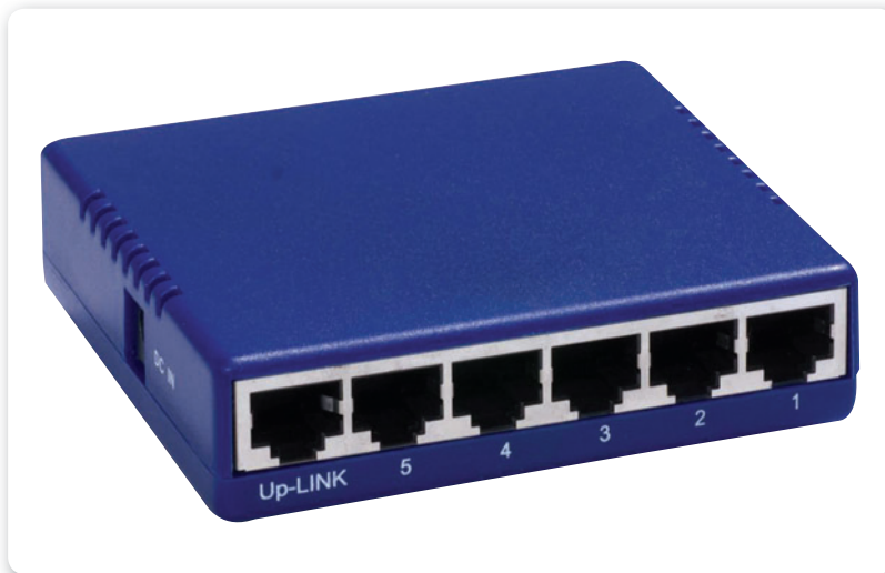
Figura 17. El hub es obsoleto, pero útil en pequeñas redes hogareñas o en espacios de trabajo reducidos.
