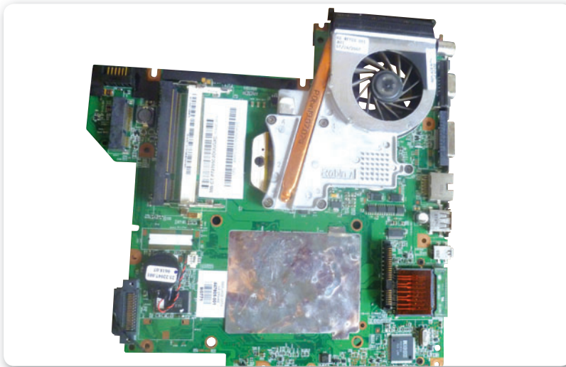
Figura 11. En la parte superior vemos el cooler, algo diferente al de una PC de escritorio.
