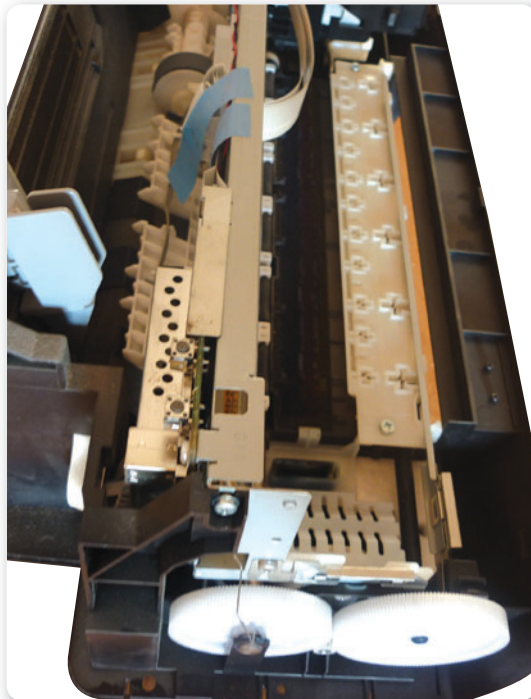
Figura 2. Aquí observamos las distintas partes que componen el circuito electromecánico de una impresora.
