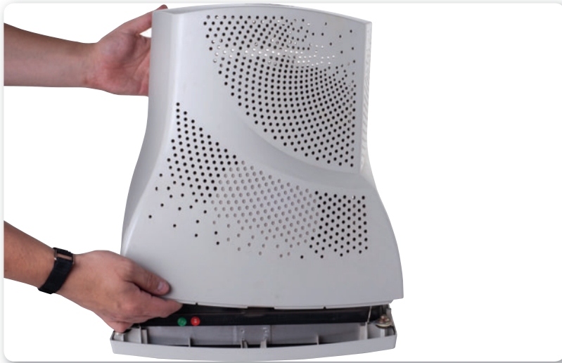
Figura 12. En la imagen podemos ver la forma en que se debe retirar la carcasa de un monitor.
