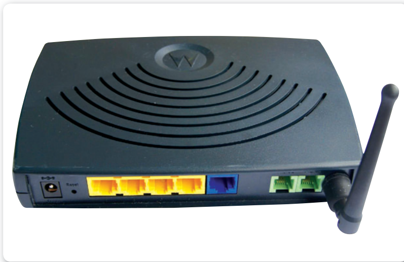
Figura 23. Router con cuatro puertos de red (amarillo), uno WAN (azul) y dos de línea (verde).
