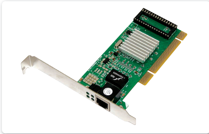
Figura 16. En redes cableadas hay un puerto Ethernet para conectar por medio de fichas RJ-45.
