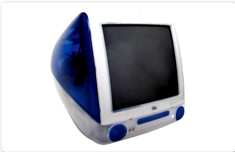
Figura 1. Las iMac G3 fueron los primeros AIO. Presentadas en 1998, no contaban con disquetera e incluían puertos USB.
