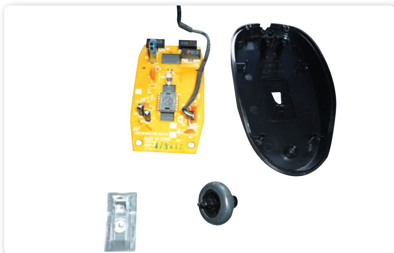
Figura 1. Aquí podemos ver un mouse óptico desarmado; en el centro de la placa se aprecia el LED emisor.
