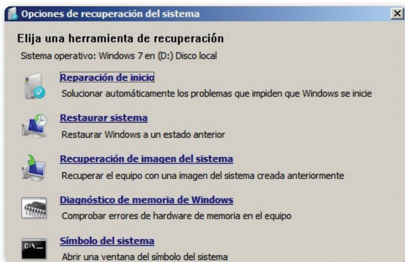
Figura 8. En esta etapa podemos elegir entre cinco herramientas de reparación o recuperación.
